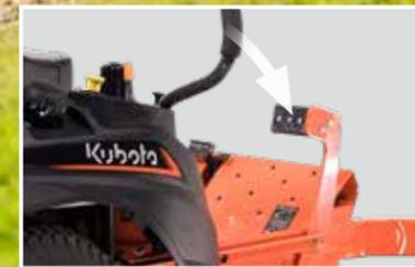
**1** Presione y suelte el pedal para elevar la plataforma.
