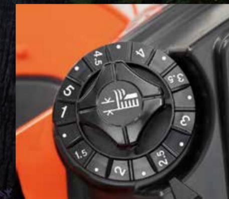
**2** Utilice el selector para ajustar la altura de corte
